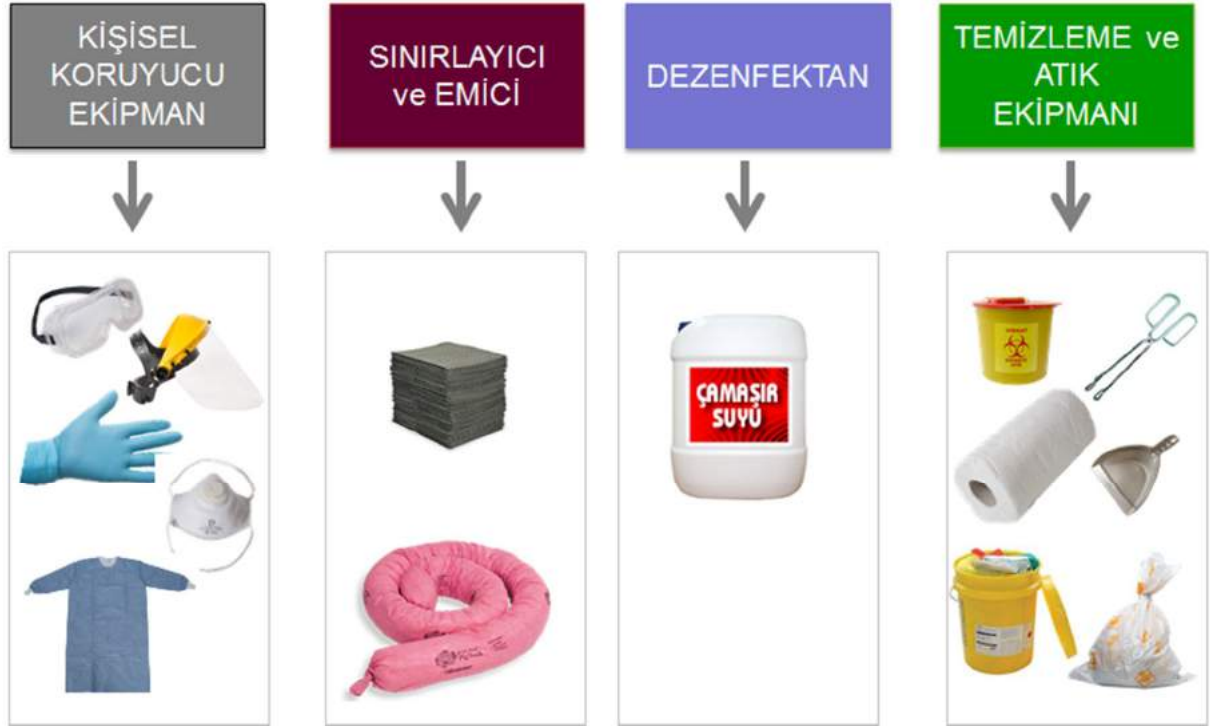
Şekil 7.19: Kimyasal dökülme-sağılma kiti içeriği
